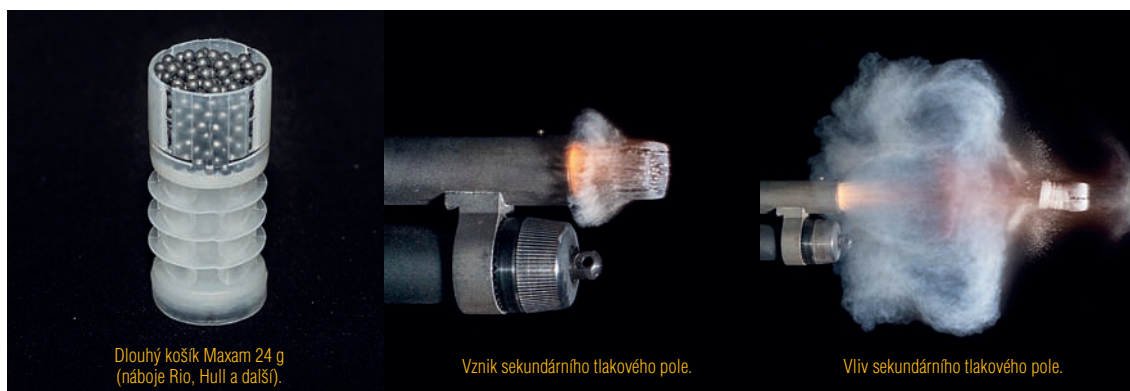
Obr. 6: Hromadná střela v okamžiku opuštění hlavně – náboj s dlouhým košíkem.
